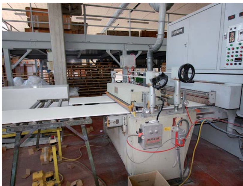
5 - Dettaglio del sistema di levigatura a 3 nastri. Detail of the 3-belt rubbing plant.
